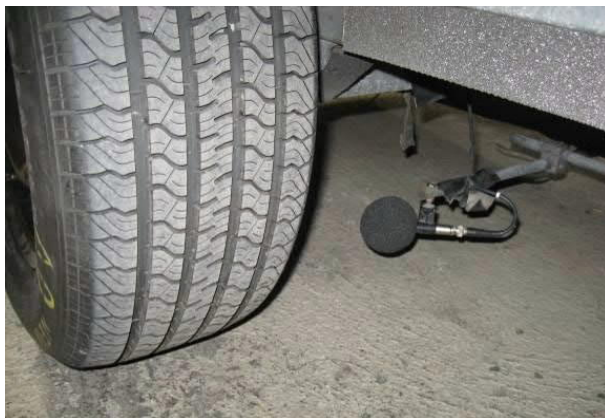
Abbildung 5. Reifen P1 mit Messmikrofon (obligatorische Mikrofonposition vorne).
