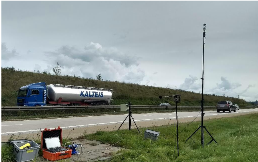
Abbildung 2. Beispielhafter Messaufbau nach der Statistischen Vorbeifahrtmethode (SPB).
