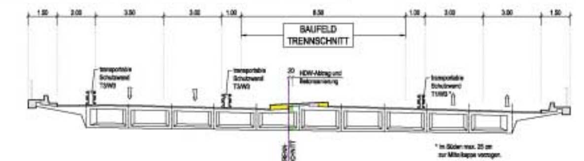
PHASE 1: Verkehrsführung 2+2/ Trennung Tragwerk Bestand
